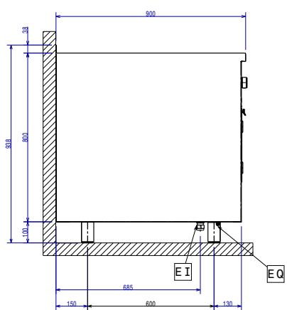
El = Conexión eléctrica (energía)
